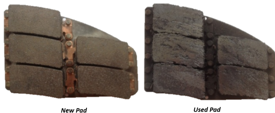
FIGURE 3 – Différents états d'une garniture de frein: du matériau "vierge" au matériau "usé".
