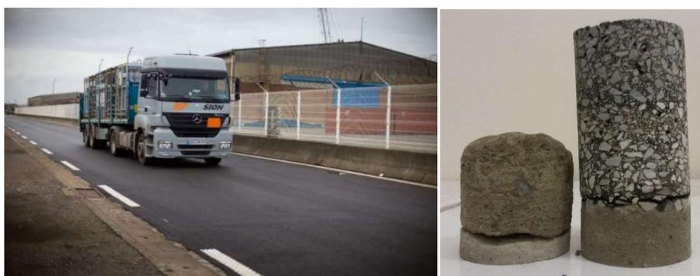
Figure 64. Route du Freycinet réalisée en 2012 par l'entreprise COLAS sur le site du Grand Port Maritime de Dunkerque (à gauche). Carotte de matériau routier collectée sur la portion formulée avec du sédiment (à droite)
