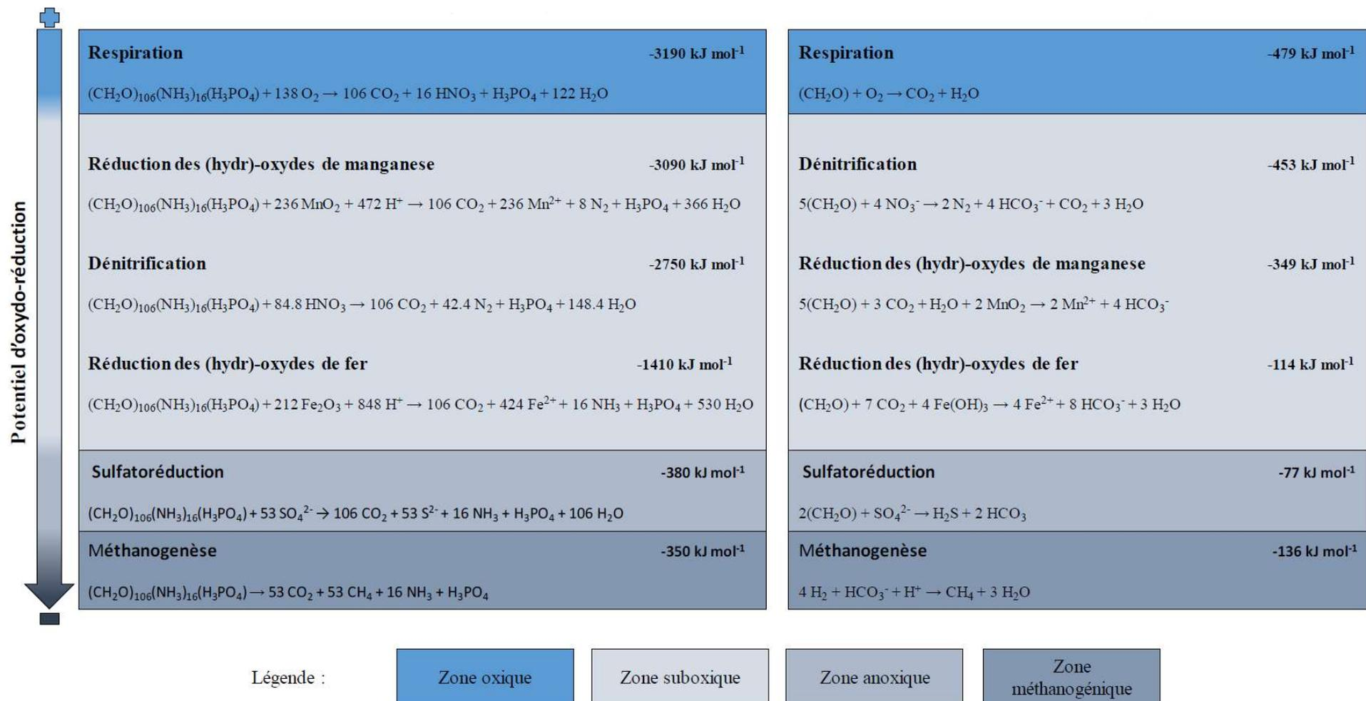
Figure 9. Séquence des réactions diagénétiques oxydant la matière organique particulaire avec les valeurs d'enthalpie libre standard de réaction correspondantes selon des expressions de réactions simplifiées (à droite [8]) et plus réalistes (à gauche [9]) d'après [10].
