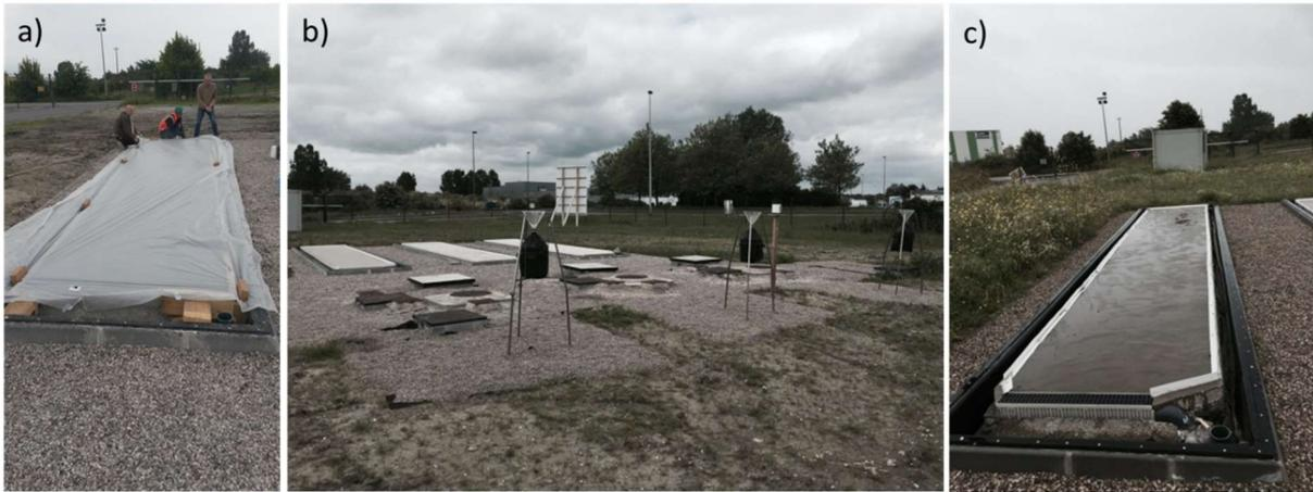
Figure 53. a) Piste lors de la réalisation du pilote ; b) Pilote comprenant les 3 pistes testées, le système de collecte des eaux et les owens ; c) Piste après un évènement pluvieux
