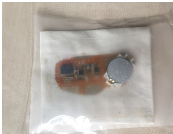
Figure 67 : Photo du circuit électronique scellé par une enveloppe en plastique étanche.
