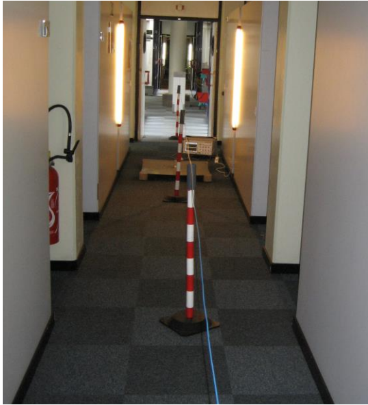
Figure 37 : Photographie d'une ligne déployée en laboratoire afin d'étudier les facteurs influençant les caractéristiques des interférences reçues par une antenne située à proximité.
