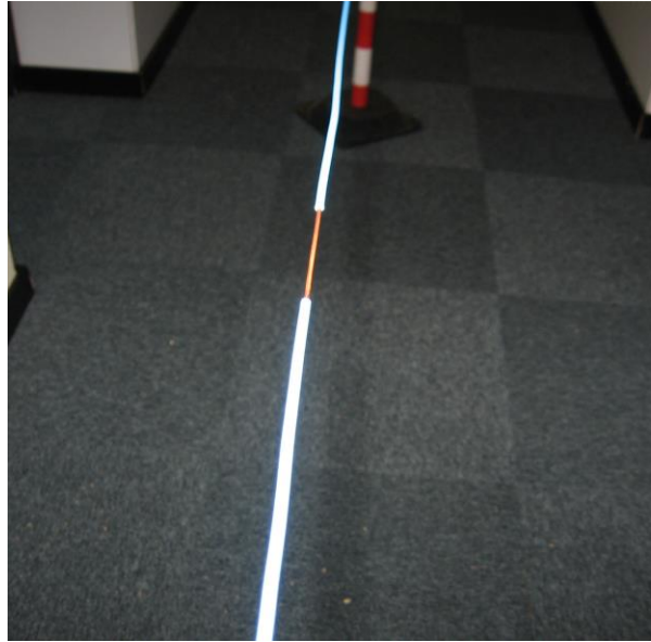
Figure 37 : Photographie d'une ligne déployée en laboratoire afin d'étudier les facteurs influençant les caractéristiques des interférences reçues par une antenne située à proximité.
